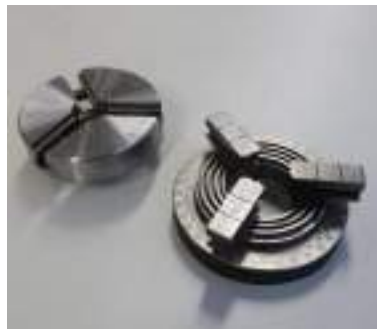
(b) スクロールチャックの構成
