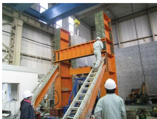
図1 梯子を使用した組換え作業
