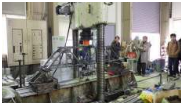
図8.載荷中の橋梁
