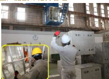
供試体の設置・運搬：クレーン・玉掛け
