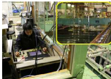
水槽実験の実施：大型水槽曳航電車
