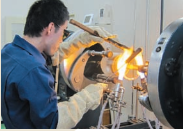
デューパー瓶の製作：大型ガラス旋盤
