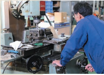
金属製部品の切削：フライス盤
