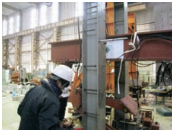
図 9.多目的載荷装置組換え
