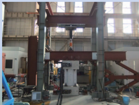
低強度コンクリート袖壁付き柱の耐震性能に関する実験的研究
