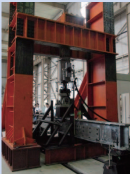
腐食した型桁の 残存強度載荷試験
