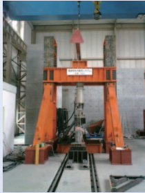
構造物加力載荷システム (50t動的荷力装置) 定格:50t
