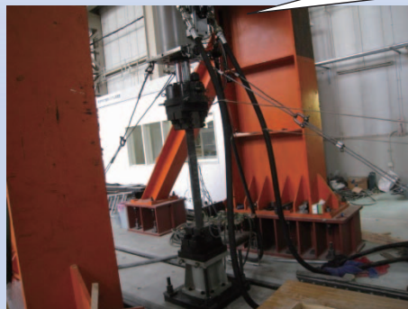
鋼板接着により性能回復された腐食板の 繰り返し載荷実験
