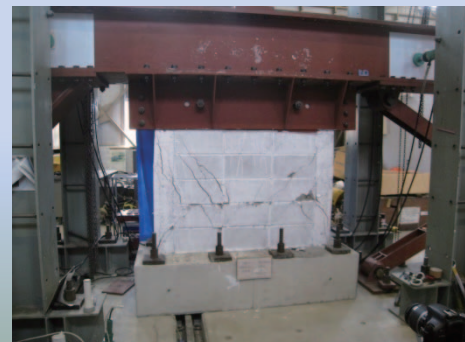
補強ブロック造壁の耐震実験
