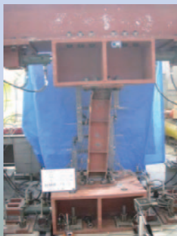
偏心ブレース架構のリンク部材の履歴性状に関する実験的研究
