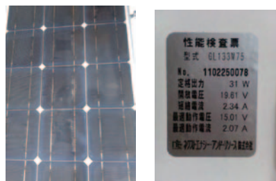
図 7. 白濁したパネルと性能検査票
