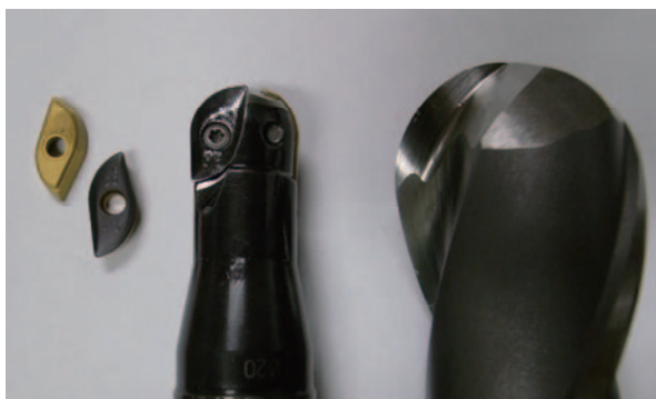
図 8. 右が R20 エンドミル, 左が R10 エンドミル, 左端が交換チップ
