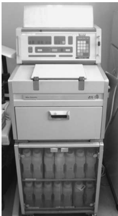
写真3 VIP (自動脱水装置)
