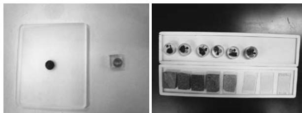
この写真は、光学系試料製作部門で製作したもので、完成した研磨片と薄片製作工程。左の写真的ガラスプレートは、ガラス素材応用部門で製作したもの。
