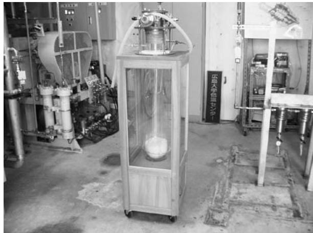
これは、超流動実験装置で、外枠を木質素材応用部門で製作し、内側のデュワービンをガラス素材応用部門で製作し、上部のフランジを金属素材応用部門で製作したもの。このように各部門で協力して、製作することもある。
