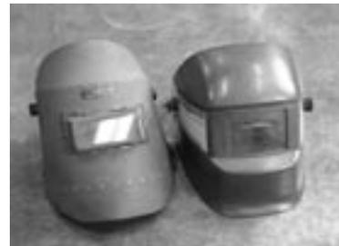
溶接加工では目の保護が重要である。溶接の加工部ではかなり強い光（紫外線など）を発生するため目を痛めてしまうことがあるためである。目の保護はもちろんだが、少しでも皮膚が露出していると日焼けをしてしまうので長袖などを着用して作業することが必要である。
