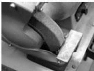
砥石を高速で回転させるグラインダは最も危険な機械の1つである。砥石とプレートの間隙が大きいと指や材料が巻き込まれることがある。この隙間を3ミリ以下とするように隙間の調整が必要である。
