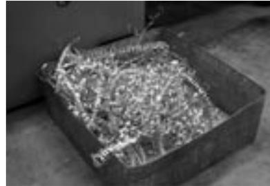
特にステンレスの切りくずはカッターの刃のように鋭く、油断をすると深い傷を負うので注意が必要である。
