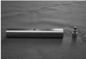
文鎮を作る材料としてステンレスを使用した。文鎮は本体とツマミに分かれていて、ツマミの全長は25ミリで、旋盤で12ミリの丸棒を11.5ミリに削り、8ミリの段をつけてダイスで6ミリのオスねじを切った。本体の部分は全長が150ミリ、径25ミリの丸棒を使い、フライス盤で平面に削った。中心にボール盤で5ミリの下穴をあけ、タップで6ミリのメスねじを立てた。
